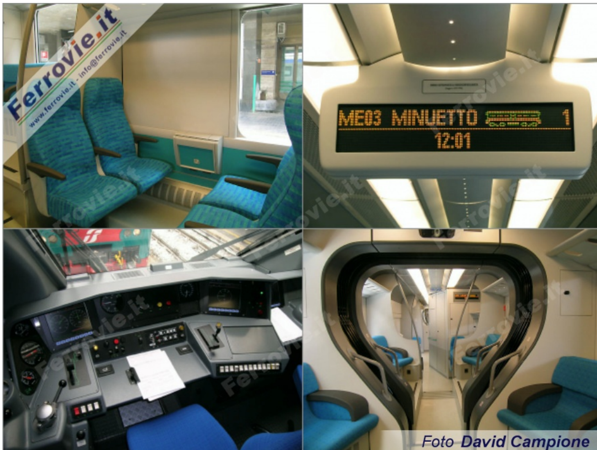
10. Da sinistra verso destra, dall'alto in basso: un modulo dell'ambiente di seconda classe, uno dei numerosi display installato a bordo, il banco di manovra e l'inusuale intercomunicante tra le due casse, posizionate su carrello centrale. In questa zona sono ubicati comodi divani affiancati, da tre posti ognuno. (Foto David Campione, 5 maggio 2004)
