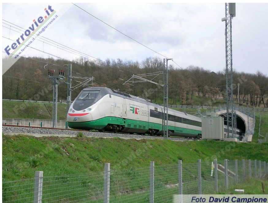
9. L'ETR.500 imbuca a forte velocità la galleria Sgurgola verso sud, durante le prove di ERTMS / ETCS senza riserva. Sulla destra un'antenna GSM-R per il collegamento radio tra terra e treno. (Foto David Campione, 25 marzo 2004)
