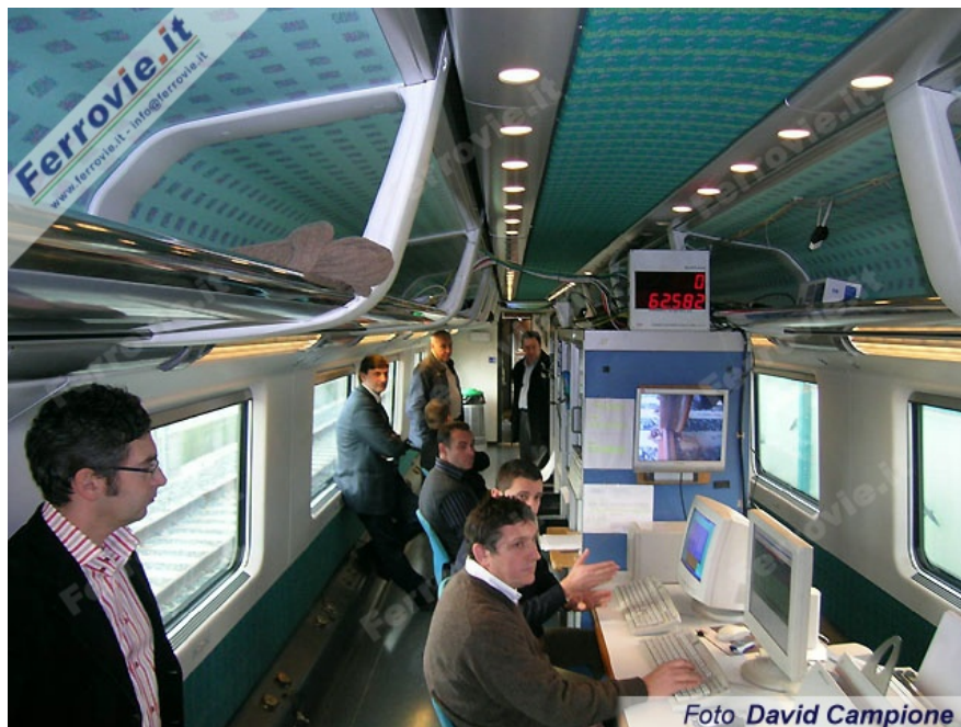
3. Una delle vetture strumentate, posta subito dietro la E.404.531, attrezzata con tachimetro digitale e monitor con visuale fissa su ruota-rotaia. Qui si è in attesa di partire per la corsa ad oltre 300 km/h. (Foto David Campione, 16 dicembre 2004)
