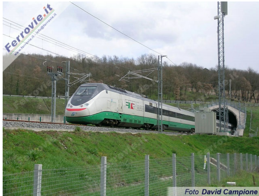
9. L'ETR.500 imbocca a forte velocità la galleria Sgurgola verso sud, durante le prove di ERTMS / ETCS senza riserva. Sulla destra un'antenna GSM-R per il collegamento radio tra terra e treno. (Foto David Campione, 25 marzo 2004)
