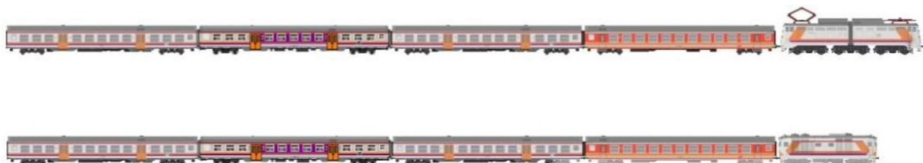
2. Disegno schematico della composizione prevista nella versione elettrica e termica. (Disegno Michele Marletta)
