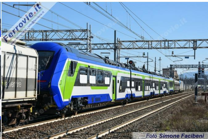
2. Particolare della cassa TP dell'HTR.412.003 "Blues", dotata del pantografo per il funzionamento del convoglio in modalità elettrica a 3000 V cc. (Foto Simone Facibeni, 01 marzo 2021)
