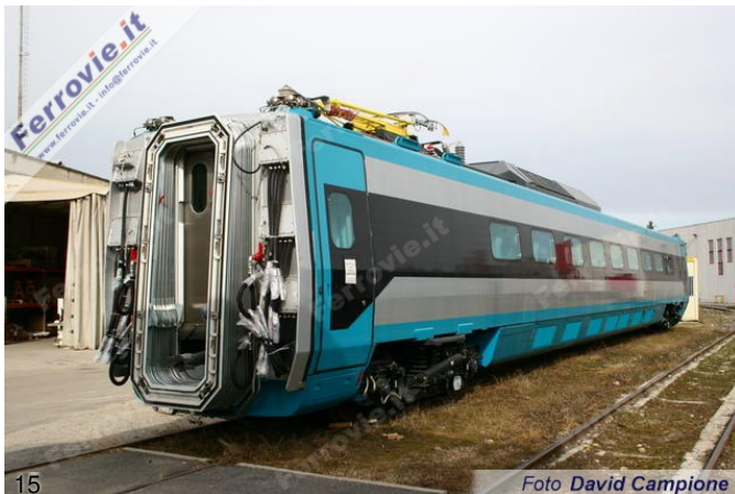
15. Cassa intermedia di un Pendolino per le Ferrovie Cechi. (Foto David Campione, 16 febbraio 2005)
