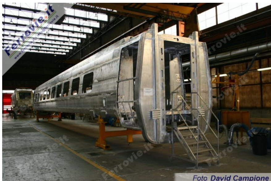
2 Carrozza intermedia per Pendolino, pressoché completo dei lavori di carpenteria. (Foto David Campione, 16 febbraio 2005)
