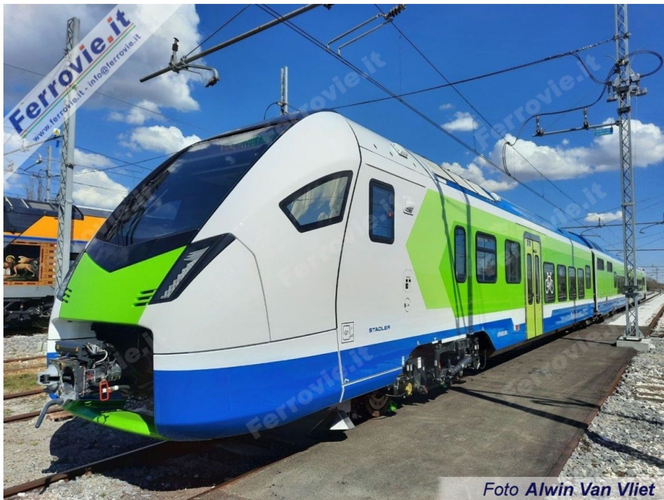
11 L'ATR 803 sul circuito RFI di Bologna San Donato, all'inizio del ciclo di prove dinamiche. (Foto Alwin Van Vliet, 16 marzo 2021)
