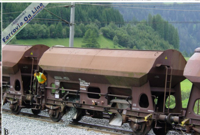
5. Dopo la sostituzione del binario, un treno cantiere è incaricato del rinnovo della massicciata. Il convoglio è in doppia simmetrica con la 2043 076... (Foto Fabio Veronesi, 25 agosto 2005) 6. ...e la 2043 052. (Foto Fabio Veronesi, 25 agosto 2005) 7. Dai carri tramoggia viene scaricato il pietrisco sotto lo sguardo attento degli addetti mentre poco più indietro una rinalzatrice attende di poter iniziare il proprio lavoro. (Foto Fabio Veronesi, 25 agosto 2005) 8. Il carro tramoggia 942 1 015-4 all'opera. (Foto Fabio Veronesi, 25 agosto 2005)
