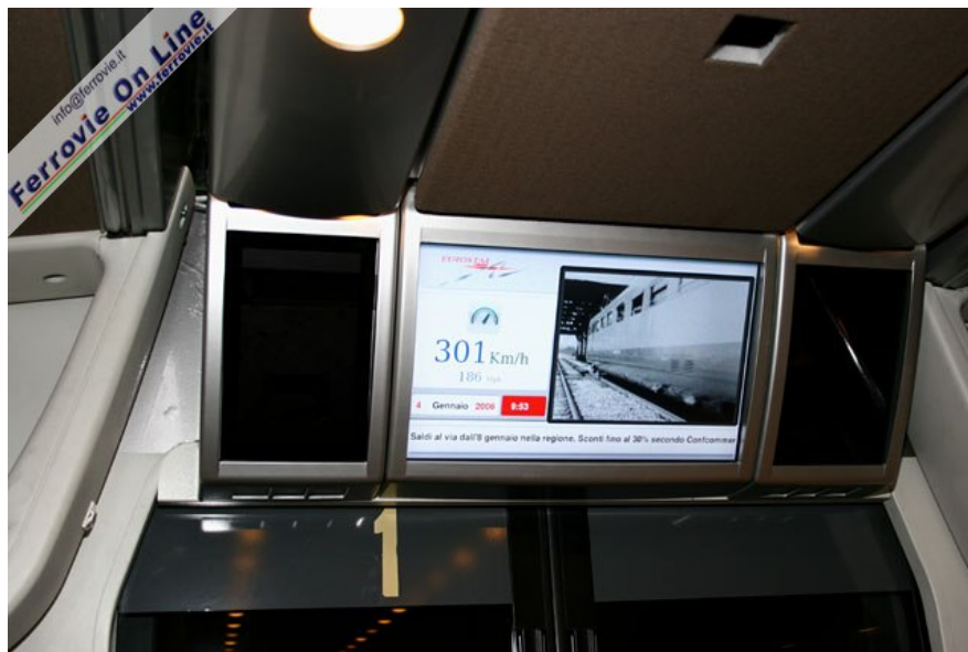
12. Il monitor a bordo dell'ETR.500 AV trasmette ininterrottamente filmati a carattere ferroviario, notizie di attualità, informazioni generiche e la velocità del treno. Qui l'ETR.500 numero 1 in corsa verso Napoli è lanciato a 301 km/h. (Foto David Campione, 4 gennaio 2006)
