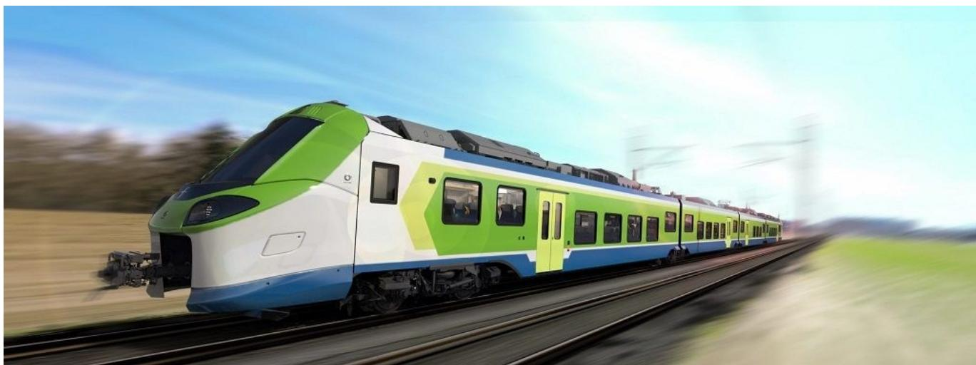
FNM ha già deliberato l'acquisto di sei elettrotreni alimentati a idrogeno, che saranno realizzati da Alstom e consegnati a Trenord entro il 2023, con opzione per la fornitura di altri otto, fino a sostituire l'intera flotta della linea, oggi composta da treni Diesel.
