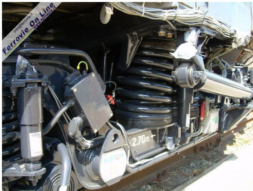
Particolare del carrello: ben in evidenza la sospensione secondaria e lo smorzatore antiseppeggio. (Foto Maurizio Tolini, 5 giugno 2006)
