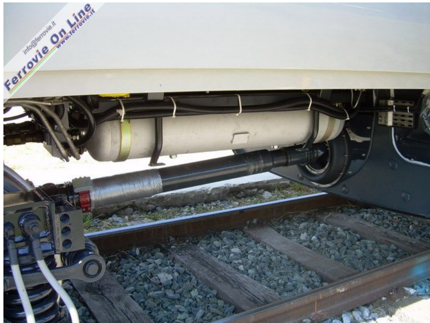
L'albero di trasmissione del nuovo Pendolino: a destra il sottocassa che ospita il motore ed a sinistra il carrello anteriore dell'elettrotreno. Foto Maurizio Tolini, 5 giugno 2006
