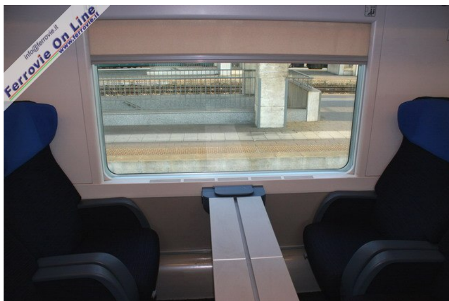
16 Particolare delle nuove tendine che hanno sostituito le veneziane interposte tra i doppi vetri. (Foto David Campione, 29 settembre 2006)
