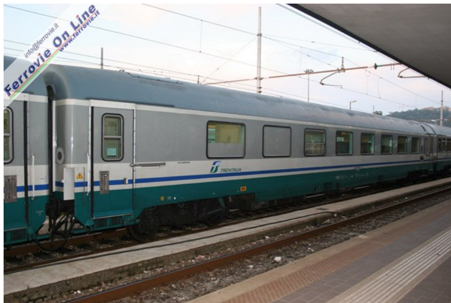
13. La carrozza speciale, ripresa lato compartimenti. Risalta in primo piano la chiusura di un finestrino ed il terzo vetro apribile, in corrispondenza del compartimento di servizio. (Foto David Campione, 29 settembre 2006)
