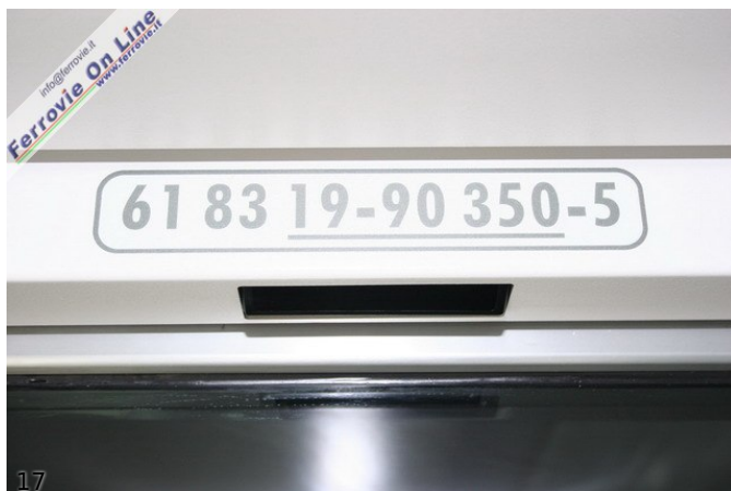
17. Particolare del sensore per l'apertura porte, ubicati a pochi centimetri dal vetro scorrevole.
