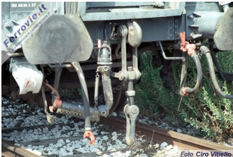
2, Particolare della testata di un bagagliaio di tipo antiquato, con in evidenza gli accoppiatori pneumatici, il REC e l'ormai scomparso riscaldamento a vapore. (Foto Ciro Vitiello, 20 settembre 1998)
