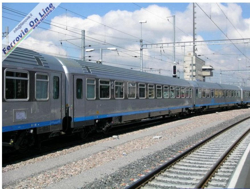
Gli EC Cisalpino vedono l'impiego di carrozze tipo UIC-Z di SBB e FS appositamente pellicate in livrea Cisalpino. Particolare di una vettura di seconda classe a compartimenti Trenitalia in sosta a Zurich HB. (Foto David Campione, 14 giugno 2004)
