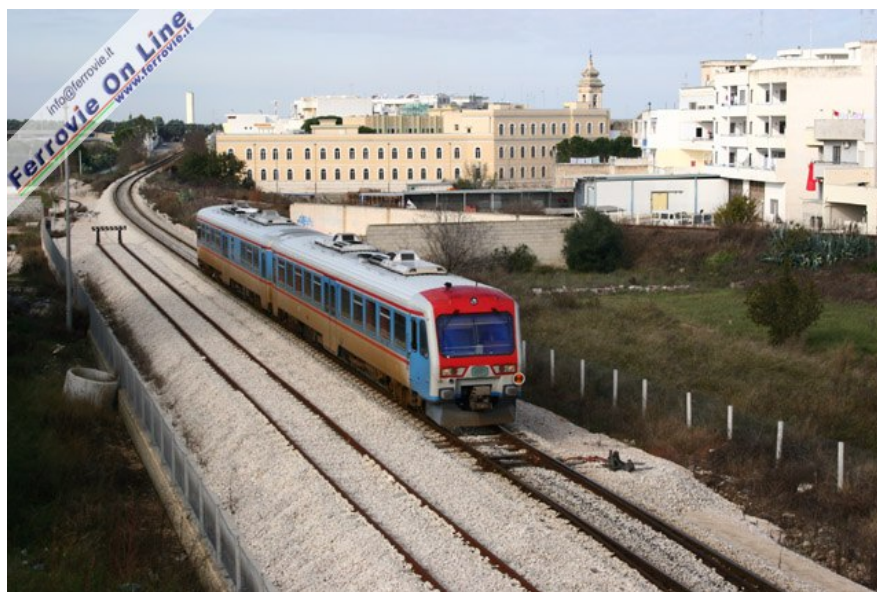
Una coppia di moderne automotrici FIAT impegna il nuovo tracciato alle porte di Noicattaro, proveniente da Bari. Qui termina il raddoppio del binario realizzato in sede nuova, mentre sullo sfondo a destra si riconosce il vecchio tracciato ferroviario oggi abbandonato. (Foto David Campione, 27 dicembre 2006)
