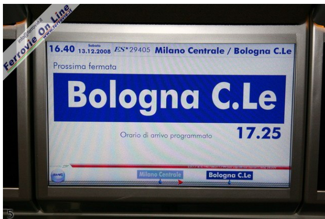
5. Il monitor di bordo con il nuovo software che sostituisce il precedente installato sull'ETR.500 n.1 fornisce informazioni sulla destinazione del treno e sull'ora di arrivo prevista. (Foto David Campione, 13 dicembre 2008)
