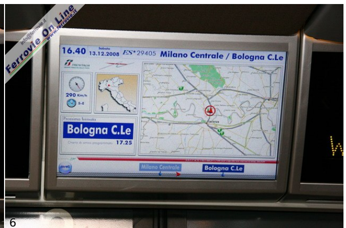
5. Il monitor di bordo con il nuovo software che sostituisce il precedente installato sull'ETR.500 n.1 fornisce informazioni sulla destinazione del treno e sull'ora di arrivo prevista. (Foto David Campione, 13 dicembre 2008)
