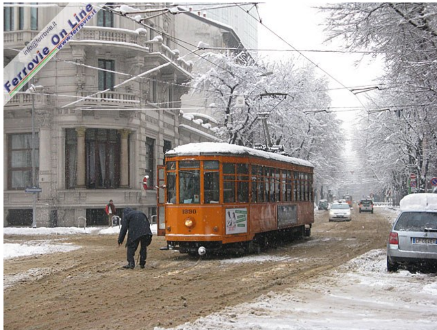
Ci si sposta all'esterno della stazione. Il maggiore problema per la circolazione tranviaria deriva dal funzionamento degli scambi. In via Fabio Filzi il tranviere tenta con grande difficoltà di girare l'ago di uno scambio per proseguire la corsa. (Foto Guido Catasta, 07 gennaio 2009)
