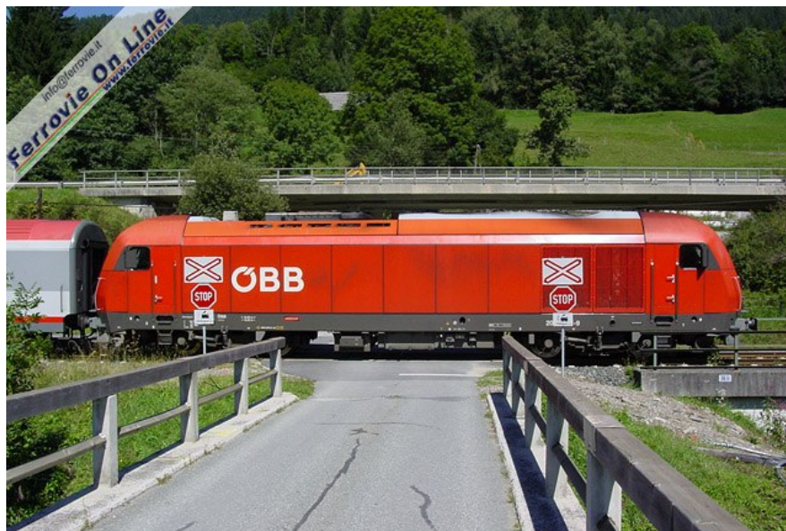
6. Se si escludono quelli posti sulle arterie principali, tutti i passaggi a livello sono privi di sbarre e di segnali luminosi. Lato strada segnali di Stop e Croci di S. Andrea avvisano che bisogna fermarsi ed accertarsi che non arrivi il treno. Il Regionale 4812 Kötschach-Mauthen - Villach HBF sta svolgendo servizio viaggiatori a Watschig, con la moderna Hercules 2016 che impegna il vicino passaggio a livello. (Foto Fabio Veronesi, 19 agosto 2008)
