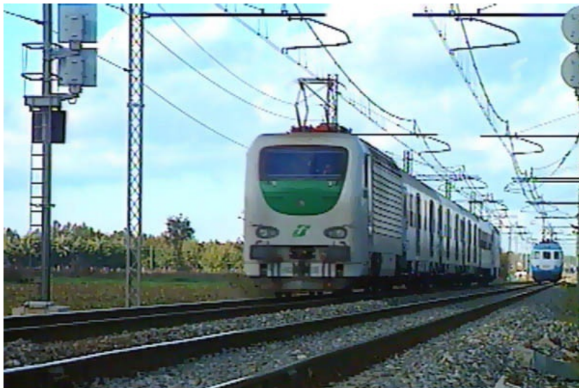
4. Le sessioni di prova hanno visto i due convogli interessati partire contemporaneamente allo stesso senso di marcia. Qui la E.402B.138 in testa al convoglio a 25 kV stacca agevolmente in velocità la ALe 540.017 alimentata dalla linea di contatto a 3 kV. (Fotogramma Studio Tecnica & Arte)
