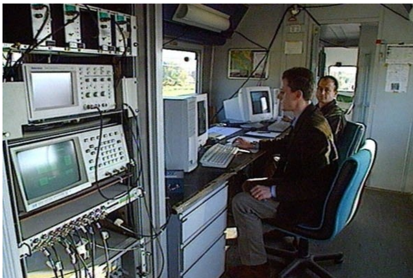
6. Interni dell'ALe 540.017 durante la corsa prova effettuata per il rilievo delle armoniche di tensione e di corrente indotte sul circuito di trazione a 3 kV in corrente continua. (Fotogramma Studio Tecnica & Arte)
