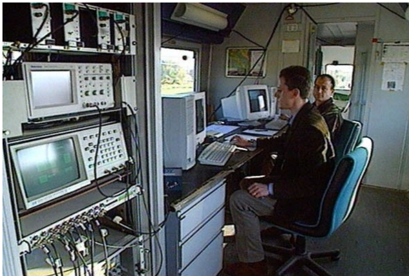
6. Interni dell'ALe 540.017 durante la corsa prova effettuata per il rilievo delle armoniche di tensione e di corrente indotte sul circuito di trazione a 3 kV in corrente continua. (Foto Studio Tecnica & Arte )
