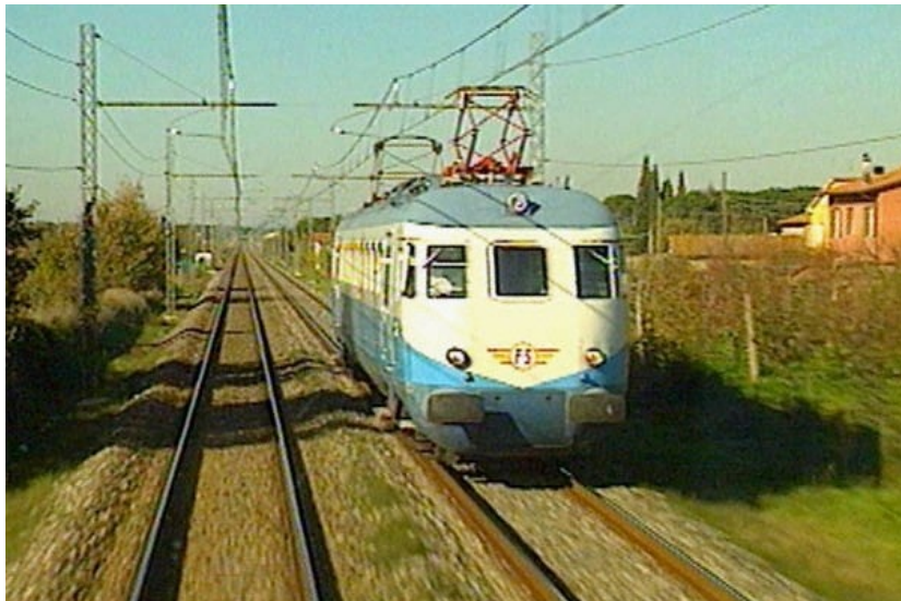
5. ALe 540.017 durante una delle corse prova tra Castiglion del Lago e Panicale. Questa ripresa permette di osservare con maggior chiarezza i due diversi pantografi installati sull'imperiale dell'automotrice. (Fotogramma Studio Tecnica & Arte)
