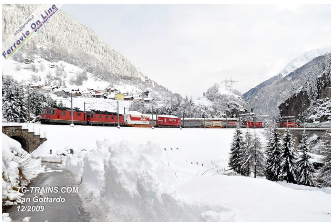
Una Re 10/10 (una Re 4/4 e una Re 6/6 permanentemente accoppiate) sta salendo verso il Gottardo con il suo treno di container. A far da proscenio una abbondante nevicata notturna. (Foto Tg-Trains.com, 1 dicembre 2009)
