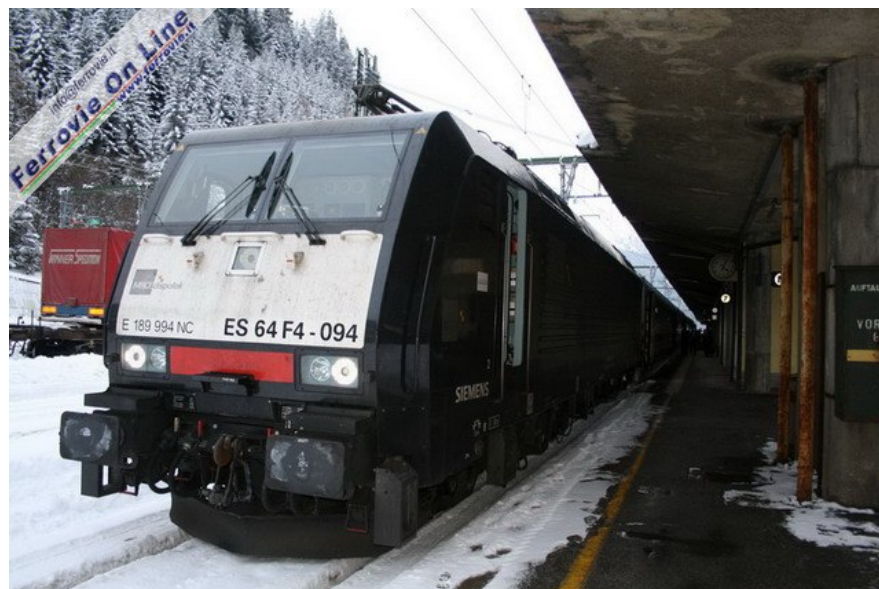
19. La E.189.994 durante la breve sosta di servizio al Brennero prima di riprendere la corsa verso la Germania. Fino al precedente orario, nella stazione di confine avveniva il cambio macchina tra quella di Trenitalia e quella delle DB o delle ÖBB. (Foto Giancarlo Scolari, 7 gennaio 2010)
