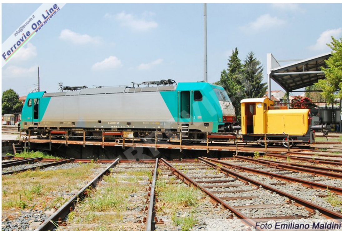
La E.483.007 NC di NORD CARGO, ricevuti gli interventi di ordinaria manutenzione e revisione, viene spinta dal piccolo automotore fino al binario alimentato, dove i tecnici BOMBARDIER effettueranno le ultime verifiche con la locomotiva sotto tensione. (Foto Emiliano Maldini, 21 luglio 2010)
