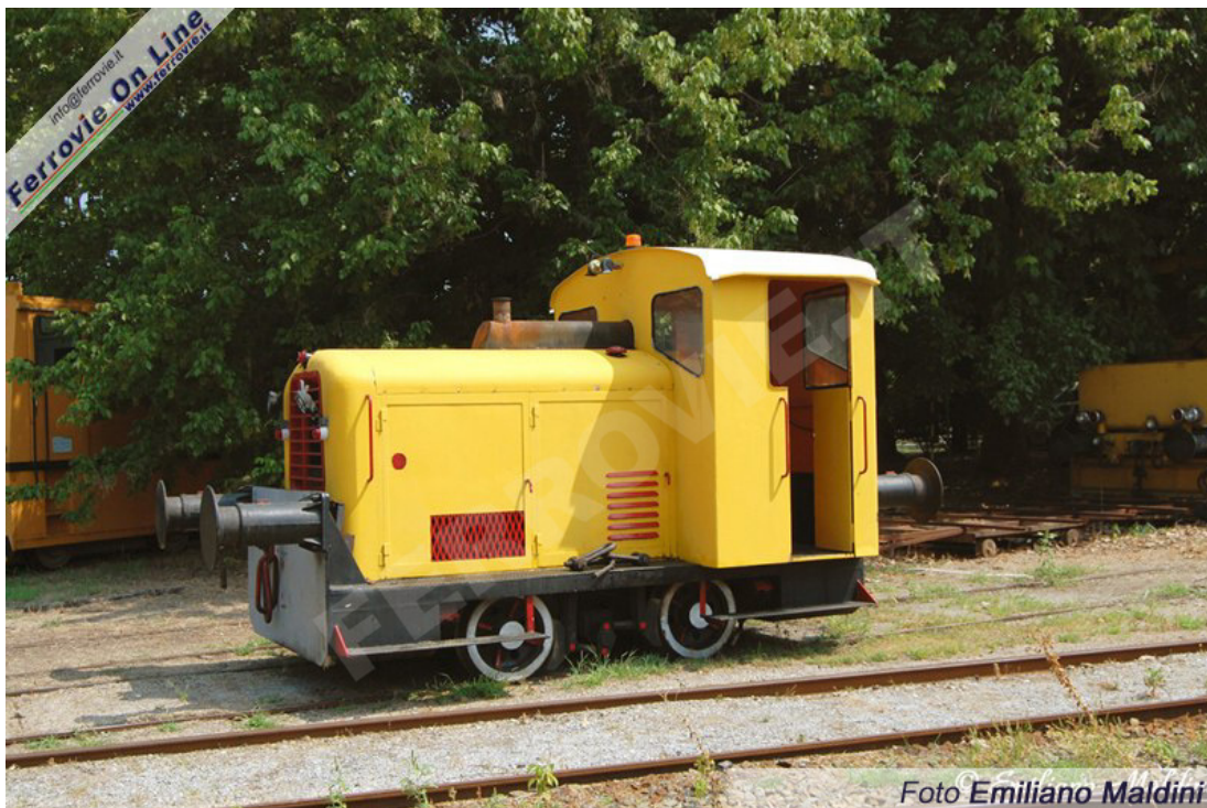
Il piccolo automotore ABL tipo V° NHT della Badoni, utilizzato dalla ditta TIBER.CO, per spostare i rotabili all'interno del deposito. Foto Emiliano Maldini, 21 luglio 2010
