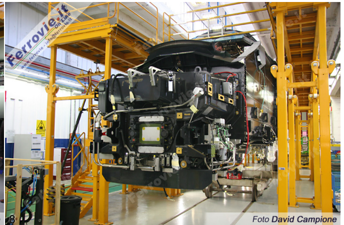
7. Carrello portante di un AGV, in attesa di essere posizionato sotto la cassa adiacente. (Foto David Campione, 30 novembre 2011)
