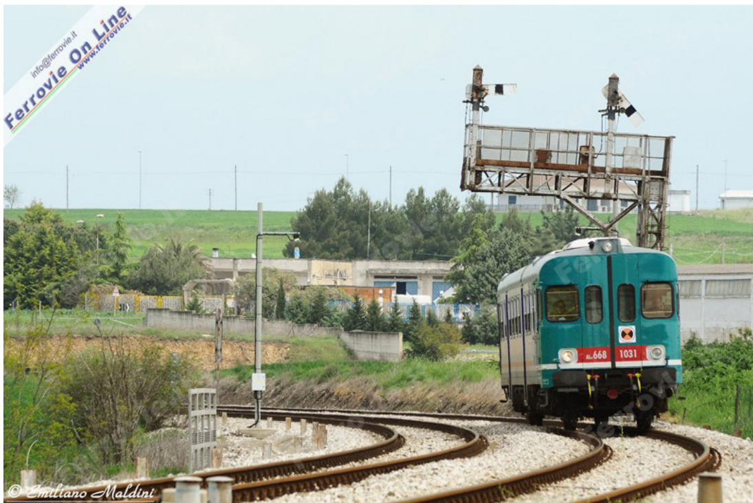
L'ala inclinata, sembra dare il benvenuto alla Aln 668.1031 che, con il Regionale 8366 da Gioia del Colle per Foggia, transita sotto il portale con i due segnali di protezione di cui quello a sinistra comanda gli ingressi dei treni provenienti dalla linea di Barletta e quello di destra comanda gli ingressi dei treni provenienti dalla linea di Gioia del Colle. (Foto Emiliano Maldini, 28 aprile 2011)
