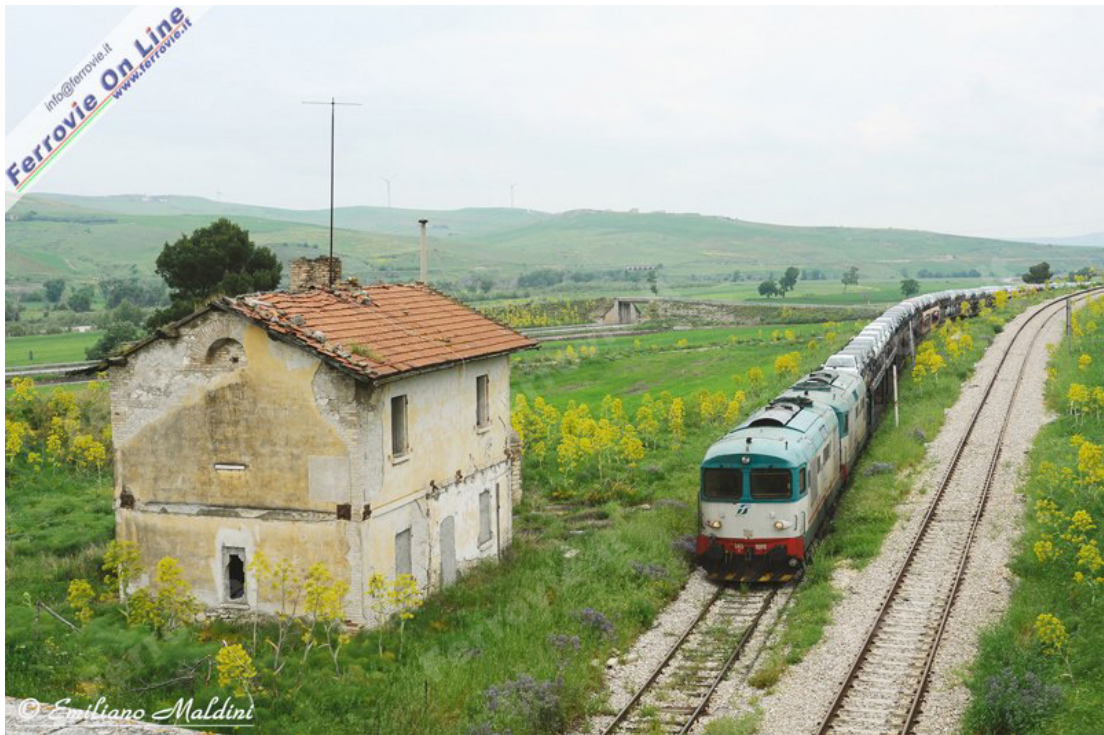
Una doppia trazione di locomotive Diesel D.345, con in testa l'unità .1080, in arrivo da San Nicola di Melfi, con un treno carico di automobili FIAT, diretto a Foggia. Sulla destra il binario della linea per Potenza, che sale con una pendenza del 28 per mille. (Foto Emiliano Maldini, 28 aprile 2011)
