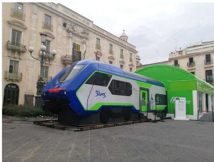
Il Blues viaggia con motori Diesel su linee non elettrificate, con pantografo sulle linee elettrificate. Una tecnologia ibrida di nuova generazione che si traduce in migliori prestazioni, in una riduzione del consumo di carburante e in una forte riduzione in termini di emissioni di CO<sub>2</sub> rispetto agli attuali convogli Diesel.
