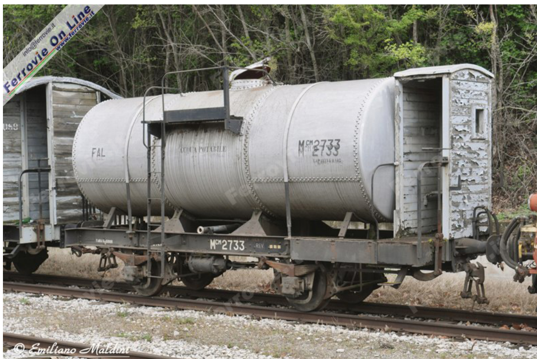
In stazione a Potenza Inferiore Scalo, troviamo invece, questo carro cisterna con chiodature e garitta per il frenatore, marcato MCM 2733. Foto Emiliano Maldini, 27 aprile 2011)
