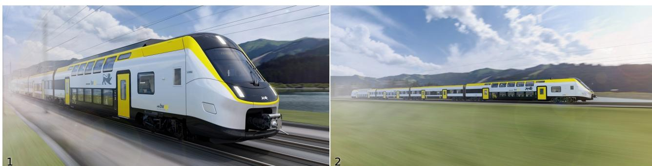
I convogli, a quattro casse, sono costituiti da due vetture di comando a due piani e due vetture intermedie a un piano, per un totale di 380 posti. Hanno una lunghezza di 106 metri e possono operare in trazione multipla. I treni sono costruiti secondo i requisiti SFBW e contribuiscono al moderno trasporto nella regione. Aria condizionata, Wi-Fi gratuito, numerose opzioni di ricarica per telefoni cellulari e laptop, nonché lampade da lettura contribuiscono a una piacevole esperienza di viaggio.
