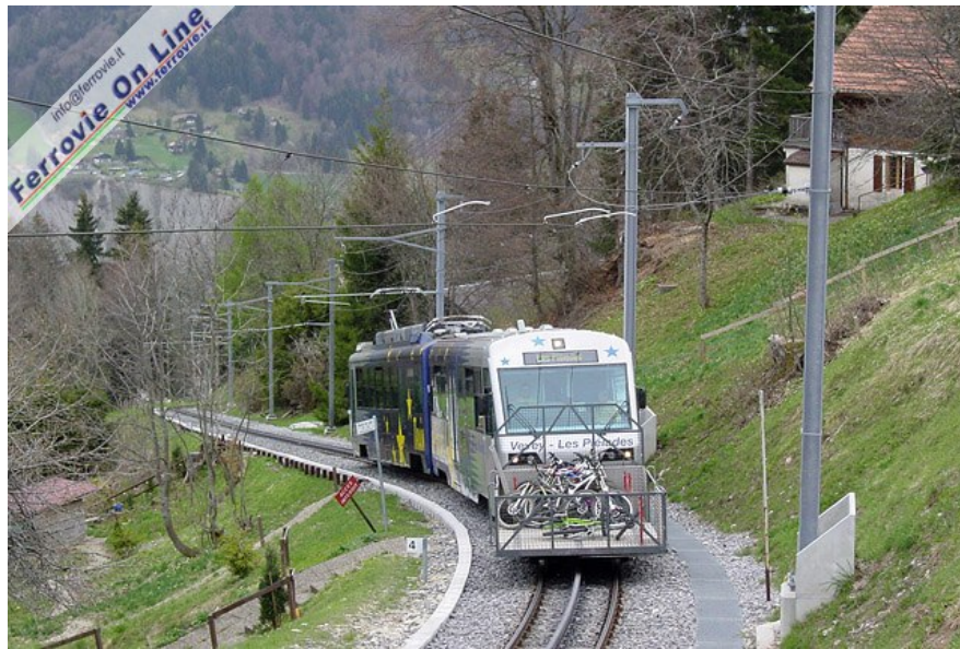
La ferrovia Vevey - Blonay - Les Pléiades è a scartamento metrico, alimentata a 900 V ed è lunga poco più di 10 km. Di fatto è suddivisa in due tronconi: il primo, fino a Blonay, ad aderenza naturale, e il successivo, con cremagliera Strub e pendenza massima del 20%, fino al capolinea superiore. Un convoglio in servizio sulla tratta superiore è qui ripreso in arrivo a Lally, con l'immane carro per il trasporto di biciclette. (Foto Fabio Veronesi, 28 aprile 2012)
