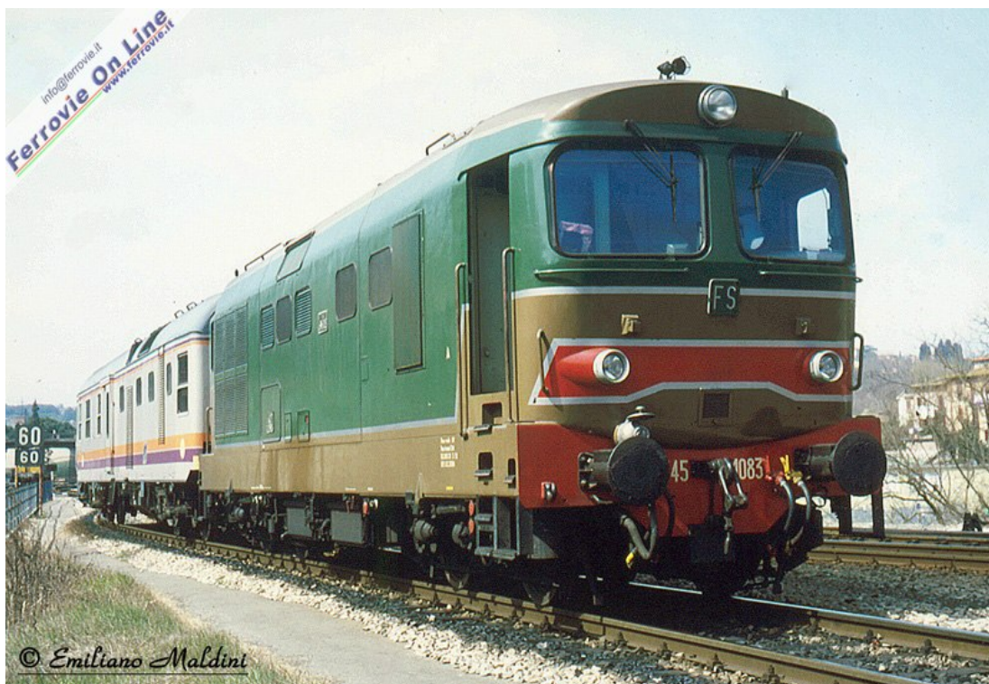
Al D.L. di Siena negli anni '90, oltre alle D.445, erano assegnate anche molte D.345 e alcuni carri generatori, in fotografia vediamo la D.345.1083, assieme ad un carro generatore nVDrec, in attesa di uscire dal Deposito, per portarsi in testa ad un treno locale per Grosseto, composto da carrozze tipo Medie Distanze, ma non reversibile. (Foto Emiliano Maldini, aprile 1993)
