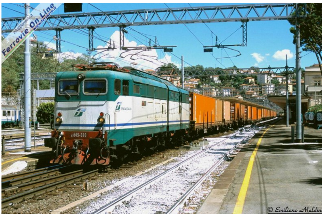
La progressiva consegna delle E.464 ed il contemporaneo accantonamento delle E.636 hanno reso possibile l'utilizzo di alcune E.646 per i servizi merci. Per questa ragione, ad un certo numero di queste locomotive venne sostituito il rapporto di trasmissione originario con uno più corto; le unità trasformate entrarono a fare parte del gruppo E.645 ed il numero progressivo d'origine venne aumentato di 300. In foto vediamo la E.645.310 (ex E.646.010) in transito a La Spezia Centrale, con un treno di container "LINEA MESSINA" diretto a Genova Sampierdarena Smistamento. (Foto Emiliano Maldini, agosto 2006)
