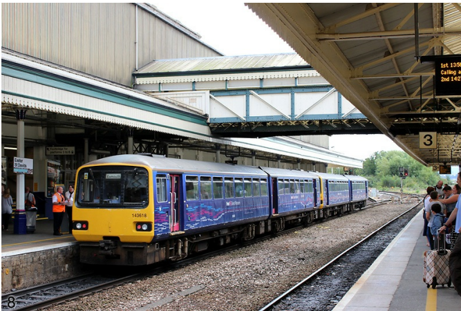
8. Doppia composizione di complessi binati classe 143 per questo treno locale Paignton-Exmouth di First Great Western. Ciascuna semiunità è un veicolo a due assi, tipologia scomparsa dalla rete a scartamento ordinario dell'Europa occidentale continentale. (Foto Jacopo Fioravanti, 30 agosto 2013) 9. Così si presenta la tranquilla cittadina costiera di Teignmouth, nel Devon, a chi arriva in treno. La stazione ferroviaria è l'edificio a sinistra oltre il muretto, con il tetto a falde grigie e la tettoia. (Foto Jacopo Fioravanti, 30 agosto 2013)
