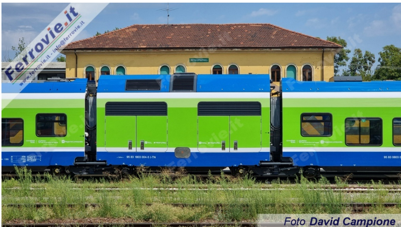
22 Particolare del modulo che ospita la motorizzazione Diesel con azionamento elettrico. (Foto David Campione, 28 luglio 2022)
