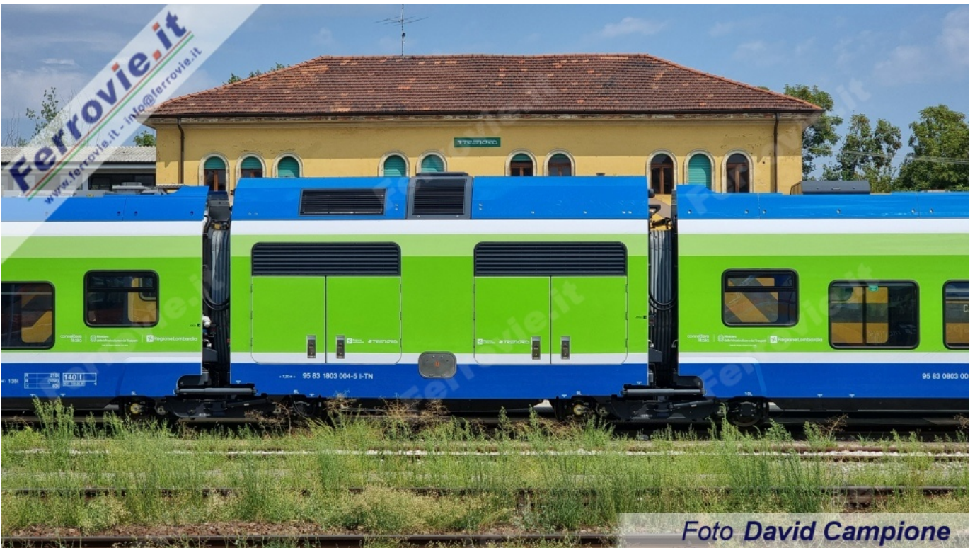
2-Particolare del modulo che ospita la motorizzazione Diesel con azionamento elettrico. Foto David Campione, 28 luglio 2022
