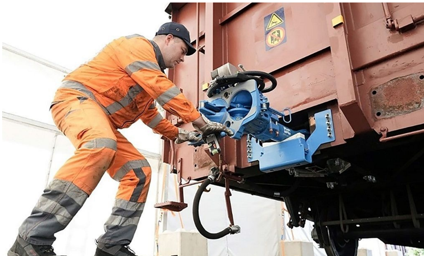
Il consueto profilo dei carri dotati di gancio a uncino e respingenti potrebbe in breve tempo lasciare posto al sistema DAC. (Foto DB - Oliver Lang)
