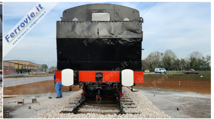
3. Lato posteriore della locomotiva, priva di marcature e con i respingenti rettangolari montati ruotati di 90 gradi.
