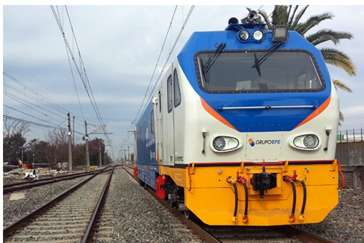
La "MRV - Maquina Registradora de Via" della cilena Grupo EFE, fornita dalla Mermec di Monopoli. Foto Mermec
