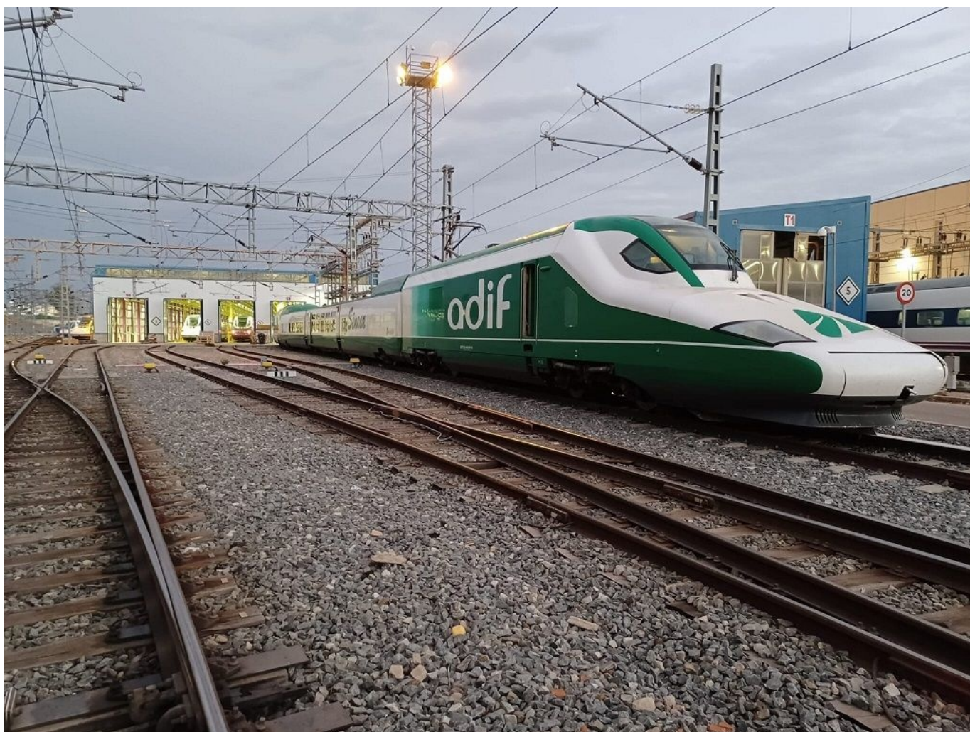
Il treno laboratorio "Seneca" di Adif, gestore dell'infrastruttura ferroviaria spagnola, è il protagonista dei test sulla rete AV. Foto Adif
