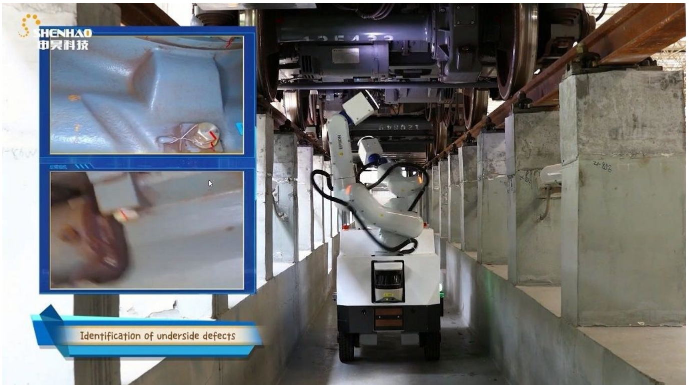
3 Il robot nella versione TVIS1000 al lavoro in una fossa di visita. (Fotogramma Shenhao)
