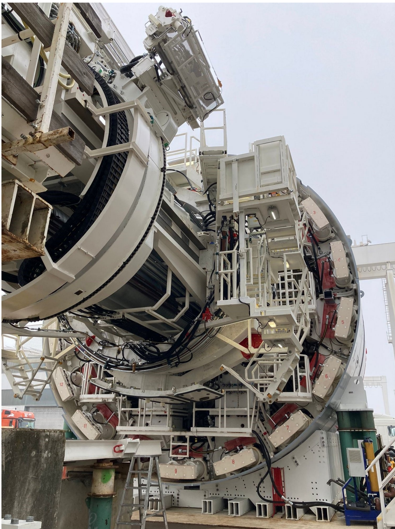
22 Struttura di back-up della TBM. (Foto BBT)
