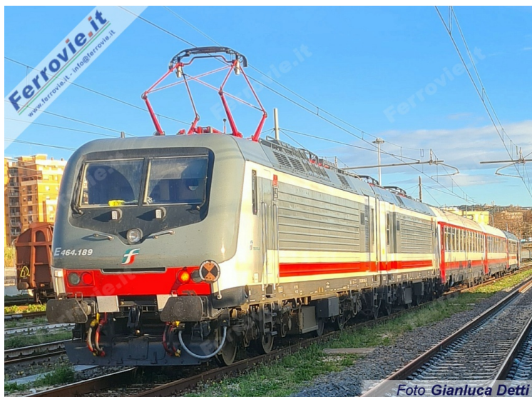
1. Le E.464.189 e 236 a Civitavecchia, in procinto di partire verso Roma con la pilota Z1A in testa. Un tratto verrà percorso a pantografi bassi, testando il funzionamento delle E.464 alimentate dalle batterie e telecomandate dalla pilota. (Foto Gianluca Detti, 22 novembre 2023)
