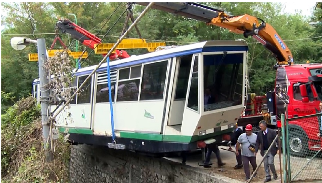
1. Una delle due vetture della funicolare di Montevergine viene rimossa dai binari per essere trasportata nell'officina che ne curerà la revisione. Foto Regione Campania, 05 ottobre 2015
