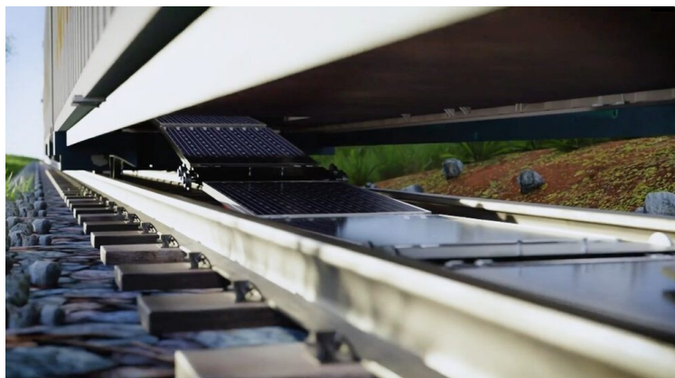
2. Posa dei pannelli fotovoltaici sui binari tramite meccanismo a pistone.
