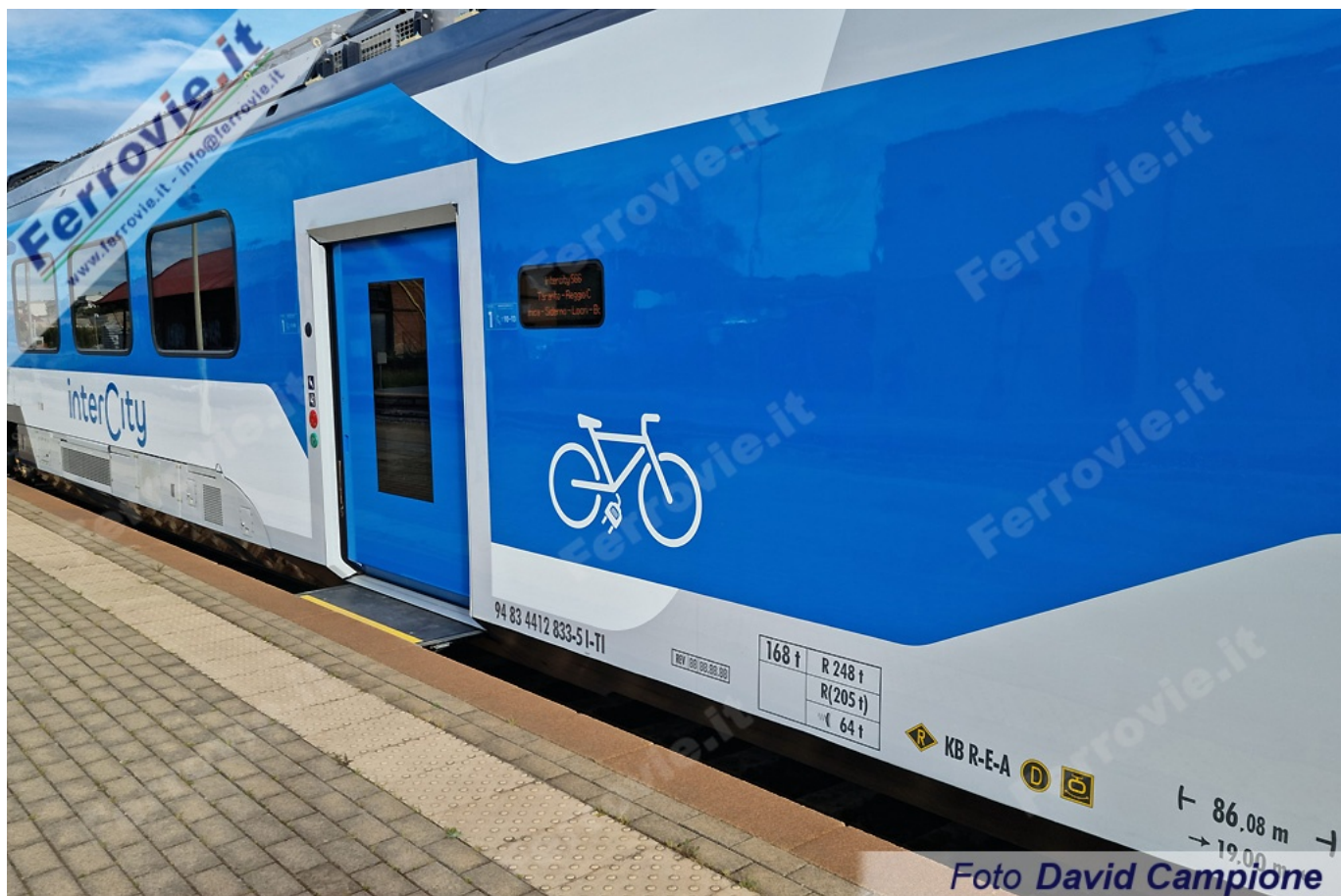
4. Porta di salita della carrozza 1 con pedana per incarrozzamento a raso. Spicca il vistoso pittogramma che identifica la zona per il trasporto bici, mentre manca per ora l'indicazione di classe. (Foto David Campione, 03 aprile 2024)
