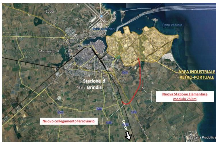
Il progetto prevede il completamento e l'attrezzaggio tecnologico della nuova stazione "Brindisi Intermodale" - che avrà quattro binari centralizzati a modulo 750 metri per arrivo e partenza treni merci - e il collegamento ferroviario della nuova stazione con la Direttive Adriatica, tramite una nuova linea elettrificata a binario unico, con allaccio del nuovo bivio (PC) "Brindisi Sud".
