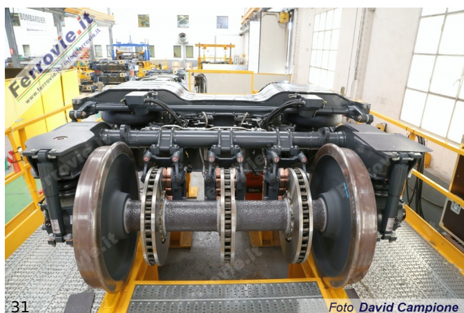
31. Carrello folle, con in primo piano i 3 dischi calettati sull'asse. (Foto David Campione)
