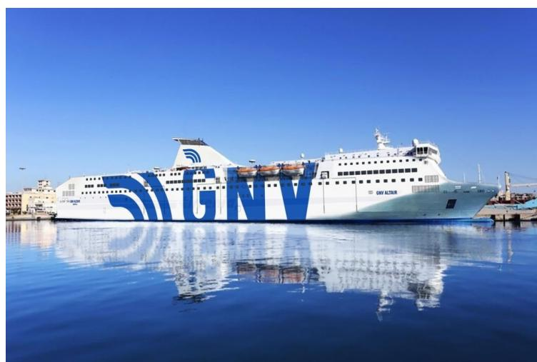
Costruita nel 2002 e precedentemente in flotta al Gruppo Moby, GNV Altair si distingue per l'elevata capacità di trasporto e per prestazioni operative di rilievo, garantendo una velocità massima di 24 nodi. La nave misura 214 metri di lunghezza e 26 metri di larghezza, con una stazza lorda pari a 35.736 tonnellate.
