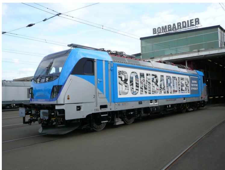
Una TRAXX AC con modulo Last Mile.
