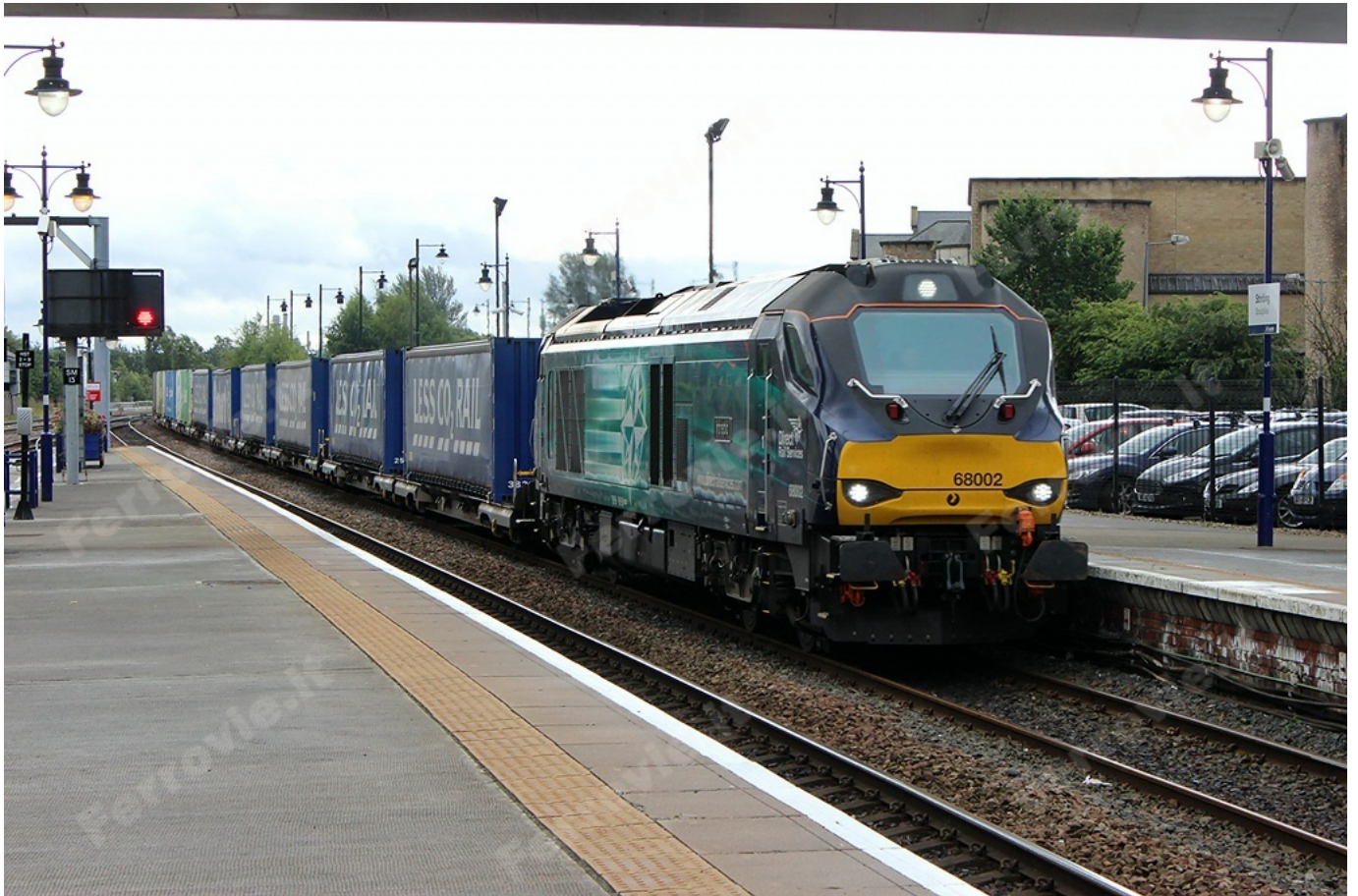
25. Nel grigiore di un pomeriggio meteorologicamente pessimo un treno carico di casse mobili transita a Stirling al traino della 68 002 di Direct Rail Services, una macchina Diesel-elettrica per servizi universali da 2800 kW di potenza installata e 160 km/h di velocità massima, costruita da Vossloh ad Albuixech nel 2013 nello stabilimento già Meinfesa, nel frattempo venduto a Stadler. (Foto Jacopo Fioravanti, 27 agosto 2015)
