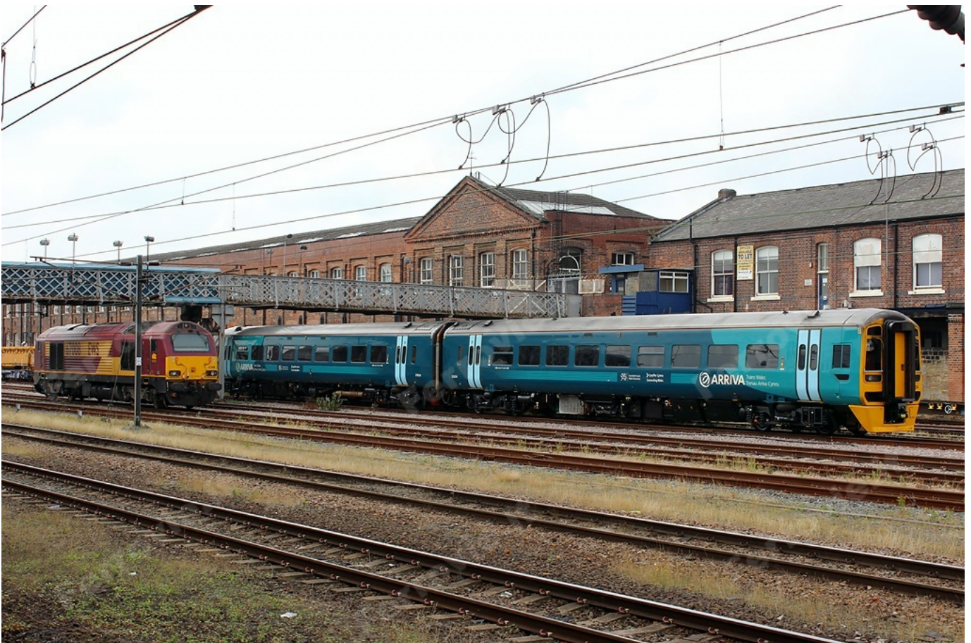
16. A Doncaster, importante nodo sulla East Coast Main Line, si incontrano rotabili appartenenti a molti operatori diversi. Qui vediamo fianco a fianco la veloce (175 km/h) locomotiva Diesel-elettrica 67 008 di DB Schenker ancora in livrea English Welsh & Scottish Railway, costruita da Alstom a Valencia nel 1999, e il binato Diesel-idraulico 158 829 di Arriva Trains Wales, appartenente alla stessa serie costruttiva di quello della foto precedente. (Foto Jacopo Fioravanti, 24 agosto 2015)
