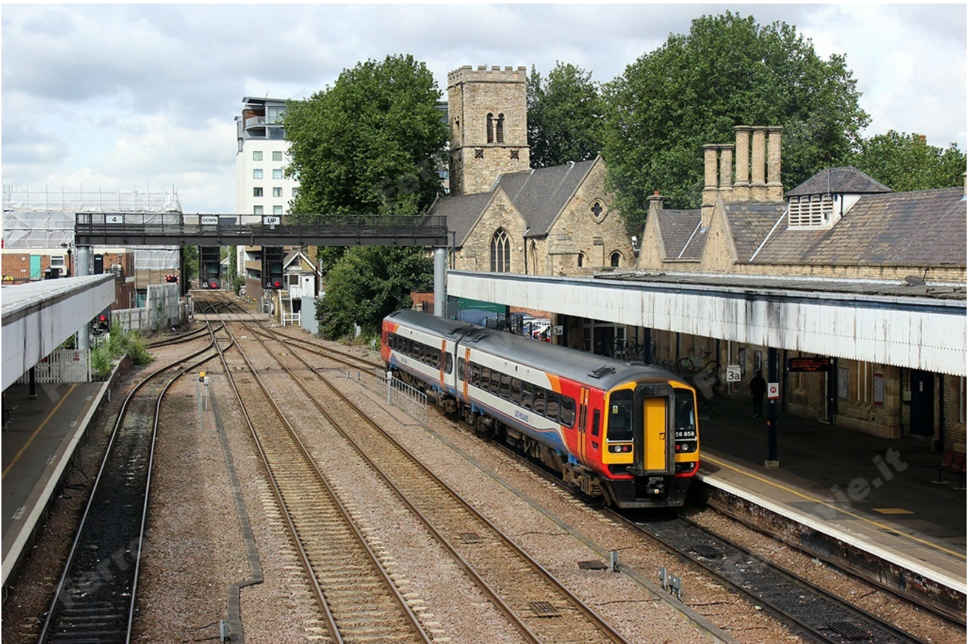
15. Prima della partenza per Edimburgo c'è ancora il tempo per qualche foto a Lincoln Central. Al marciapiede 3a il binato Diesel-idraulico 158 858 di East Midlands Trains, costruito da BREL a Derby nei primi anni Novanta, si appresta ad effettuare il treno 2L60 delle 10:36 per Leicester. E' un rotabile abbastanza prestante, con cassa in lega d'alluminio, 520 kW di potenza installata e velocità massima di 145 km/h, caratteristiche che lo mettono a suo agio anche nell'espletazione di servizi veloci a medio raggio. (Foto Jacopo Fioravanti, 24 agosto 2015)
