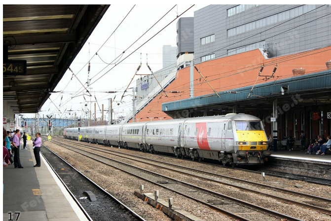
17. Con due minuti di ritardo sull'orario assegnato, alle 12:55 arriva il treno 1E10 di Virgin Trains East Coast da Edinburgh Waverley per London King's Cross, composto da vetture Mark 4 spinte dalla locomotiva elettrica 91 113. Si noti che le vetture sono ancora nella livrea del precedente operatore, East Coast; solo il DVT in testa ha ricevuto una vistosa fascia rossa obliqua con il logo Virgin. (Foto Jacopo Fioravanti, 24 agosto 2015)
