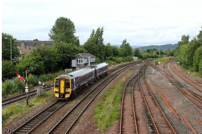
26. Dal cavalcavia di Forth Place, volgendo l'obiettivo in direzione opposta rispetto alla foto precedente, si ottiene questa inquadratura della radice nord della stazione di Stirling nella quale si distinguono la linea a semplice binario per Alloa e Dunfermline, sulla destra, e quella a doppio binario per Perth, sulla sinistra, sulla quale si sta avviando il treno 2N51 di ScotRail da Glasgow Queen Street per Dundee, effettuato dal binato Diesel-idraulico 158 724. (Foto Jacopo Fioravanti, 27 agosto 2015)
