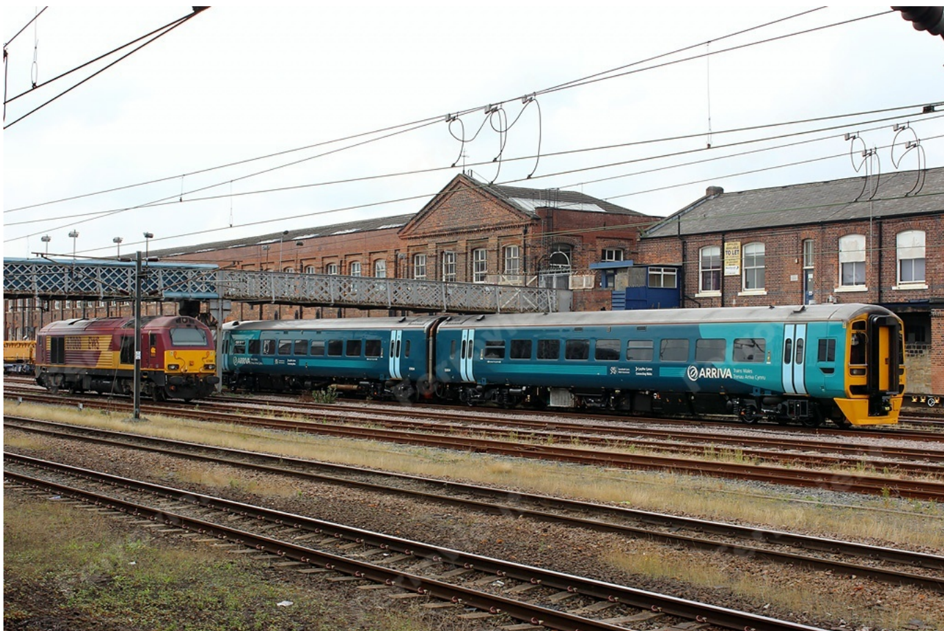
16. A Doncaster, importante nodo sulla East Coast Main Line, si incontrano rotabili appartenenti a molti operatori diversi. Qui vediamo fianco a fianco la veloce (175 km/h) locomotiva Diesel-elettrica 67 008 di DB Schenker ancora in livrea English Welsh & Scottish Railway, costruita da Alstom a Valencia nel 1999, e il binato Diesel-idraulico 158 824 di Arriva Trains Wales, appartenente alla stessa serie costruttiva di quello della foto precedente. (Foto Jacopo Fioravanti, 24 agosto 2015)
