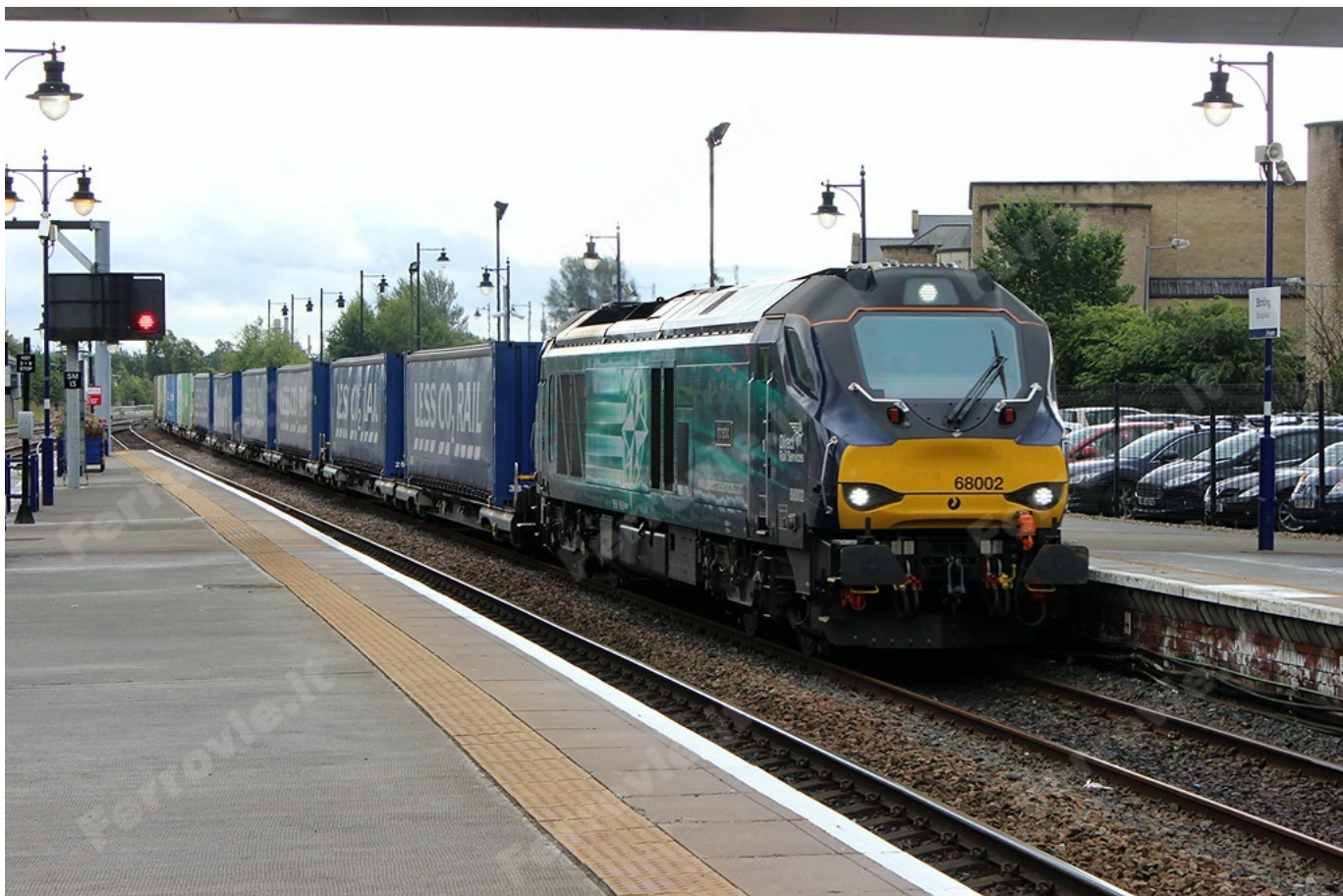
25. Nel grigiore di un pomeriggio meteorologicamente pessimo un treno carico di casse mobili transita a Stirling al traino della 68 002 di Direct Rail Services, una macchina Diesel-elettrica per servizi universali da 2800 kW di potenza installata e 160 km/h di velocità massima, costruita da Voessloh ad Albuixech nel 2013 nello stabilimento già Meinfesa, nel frattempo venduto a Stadler. (Foto Jacopo Fioravanti, 27 agosto 2015)
