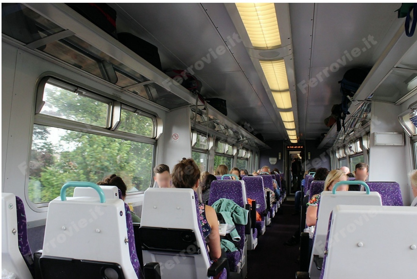
3. Gli interni a classe unica delle automotrici doppie Classe 156. Sono evidenti l'esiguità dello spazio individuale a disposizione dei passeggeri, le aguste bagagliere e i sedili piccoli e dotati di schienale molto basso, caratteristiche che rendono questi rotabili del tutto inadeguati ai servizi a medio raggio. (Foto Jacopo Fioravanti, 28 agosto 2015)
