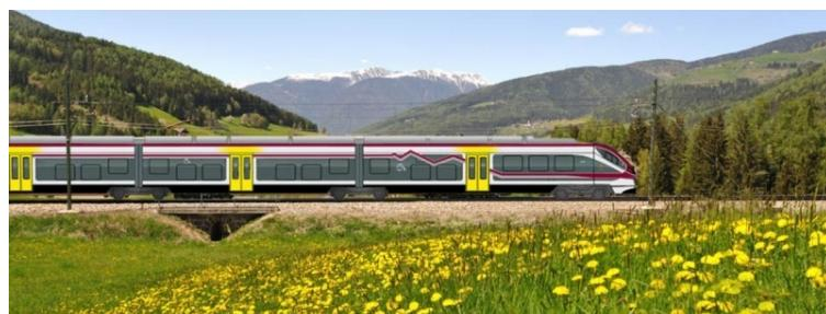
Gli elettrotreni potranno raggiungere la velocità massima di 160 km/h ed a bordo disporranno di impianto di video sorveglianza, schermi luminosi informativi (interni) visibili da ogni punto del treno, impianto di sonorizzazione, scritte in Braille, prese di corrente a 220 V per l'alimentazione di cellulari e PC portatili. Infine saranno 20 le bici trasportabili al seguito dei viaggiatori (anziché 8 come sui Jazz già in servizio).
