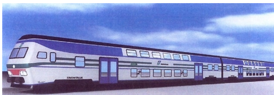
3. Nel disegno le nuove vetture a due piani (31 carrozze e 7 semipilota), che avranno una velocità di esercizio massima di 160 km/h. 126 in seconda classe, 94 in prima e nella semipilota di seconda i posti a sedere con un modulo abitabile di 1700 mm ognuno dotato di prese di corrente a 220 v e 50 Hz. Ogni vettura è dotata di aria condizionata, incarrozzamento a raso, informazione sonora e visiva per i passeggeri. Grossa attenzione è stata riservata per i non vedenti con mappe tattili nei vestiboli, sulle fiancate e con caratteri Braille in rilievo sulle pulsantiere. La zona per i disabili è posizionata nella semipilota. Inoltre saranno allestite zone polivalenti per trasportare per esempio biciclette e sci attrezzabili anche con distributori automatici di bevande e snack. (Foto Trenitalia, 17 giugno 2004)
