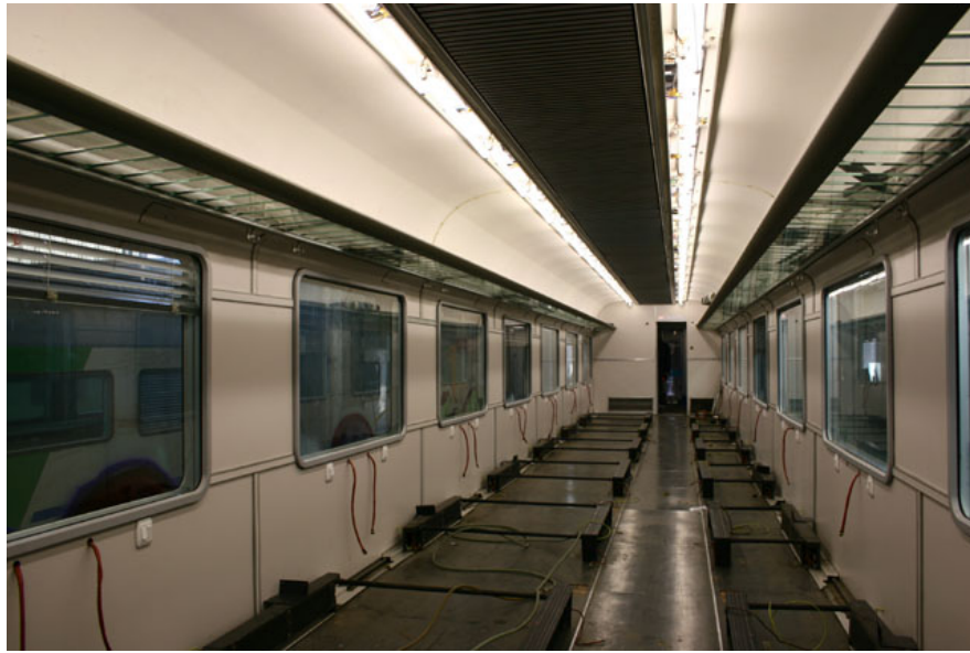
Un'altra Gran Confort, in una fase più avanzata di lavorazione. Sono stati ripristinati i neon, i pannelli laterali e le nuove pulsantiere per le tendine veneziane incorporate nei finestrini; alla base si riconoscono le linee di alimentazione a 220 Volt che verranno alloggiare nei tavolini. (Foto David Campione, 5 gennaio 2005)
